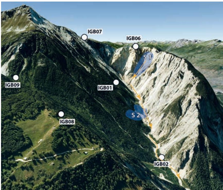
Abb. 5: Wechselbeziehungen von Erdoberflächenprozessen im Illgraben, Schweiz. Steinlawineneignis S_1 löst den dritten Murgangpuls aus, der sich im Gerinne stromabwärts bewegt (orange Pfeile). Durch Erosion des Ufers wird eine weitere Steinlawine, S_2 , aktiviert. Seismometerstationen (weiße Kreise mit Stationsnummern IGB01 bis IGB10, nicht alle Stationen sind sichtbar) zeichnen diese Kette von Ereignissen auf und geben so Einblick in die Wechselwirkungen von Prozessen. (Foto: Google Earth)
